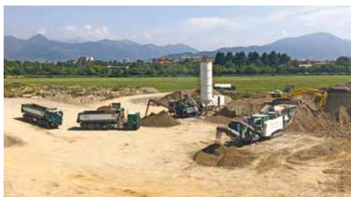
**5A e 5B.** L'area di produzione con l'impianto mobile Wirtgen KMA 200
